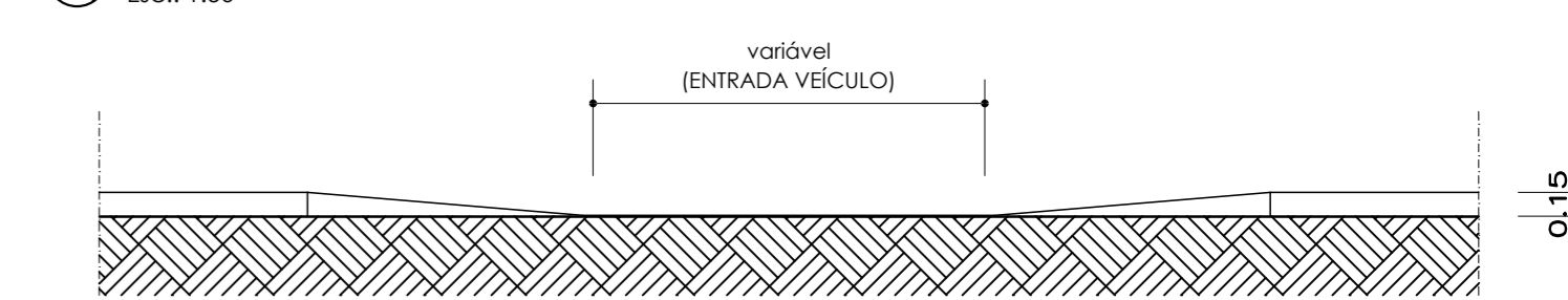
DETALHE 1 - VISTA -RAMPA VEÍCULOS Esc.: 1:50
