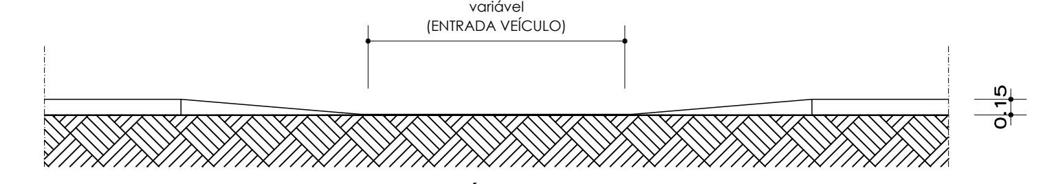
DETALHE 1 - VISTA - RAMPA VEÍCULOS Esc.: 1:50
